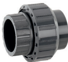
Raccord union GEMÜ 1035 en plastique PVC-U gris, PP ou PVDF, DN 10 à 100
